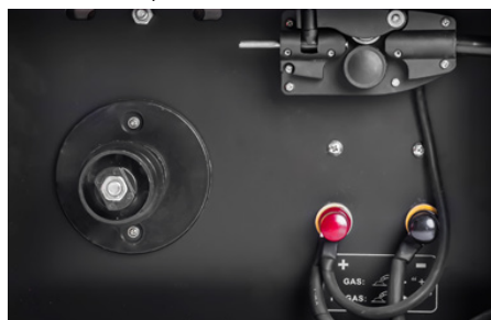
„GAS“ - soldadura MIG „NO GAS“ - soldadura con hilo revestido (FLUX) Preparación de la unidad de alimentación del hilo
