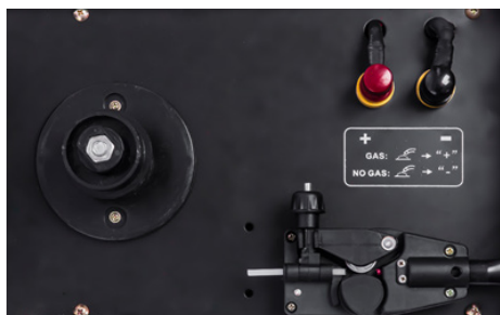
„GAS“ - soldadura MIG „NO GAS“ - soldadura con hilo revestido (FLUX) Preparación de la unidad de alimentación del hilo
